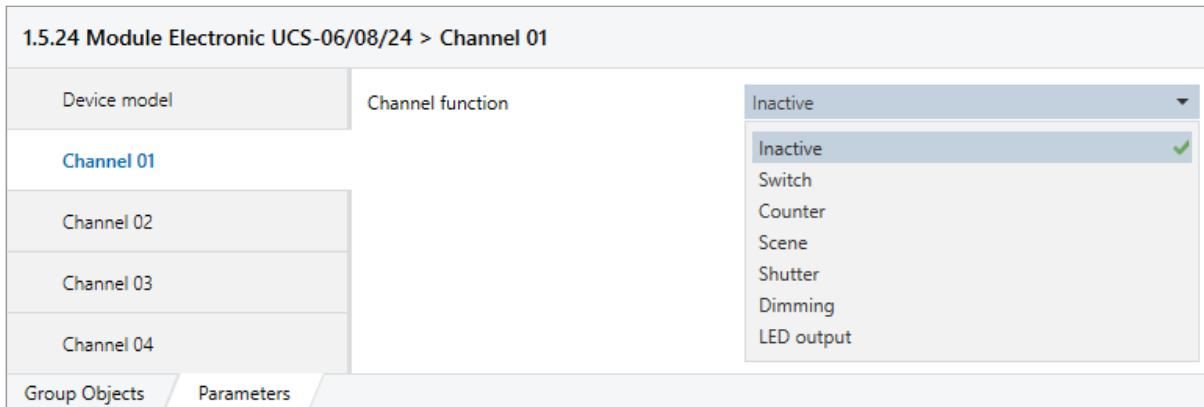
Figure 2. Tab «Channel 01» in the «Inactive» mode
